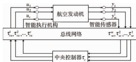
图1 航空发动机分布式控制系统结构图
